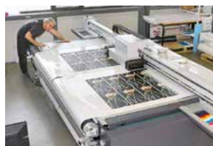
Diverse flexible und starre Materialien wie zum Beispiel Plexiglas können bedruckt werden.
